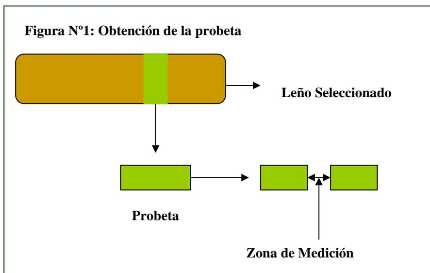
Se deberá obtener la probeta correspondiente a la muestra seleccionada la cual deberá ser partida con el fin de medir el Contenido de Humedad de forma perpendicular a la fibra de la madera. Nunca se debe medir el leño seleccionado en la cara superficial ya que esto lleva a mediciones que no tienen relación con el verdadero Contenido de Humedad, la medición debe abarcar el interior de los leños.
